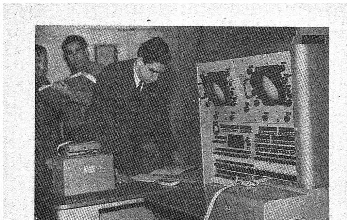
Stolik operatora w maszynie ZAM-2. Na pierwszym planie wyjście taśmowe (reperforator), dalej wejście (czytnik taśmy).
