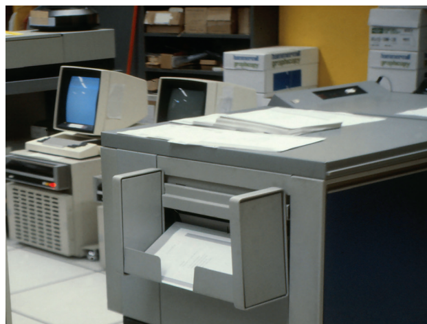
Stacje Alto pełniące funkcję serwera plików i serwera wydruków, na pierwszym planie drukarka laserowa, z lewej strony stacja dużych dysków dołączona do serwera plików
