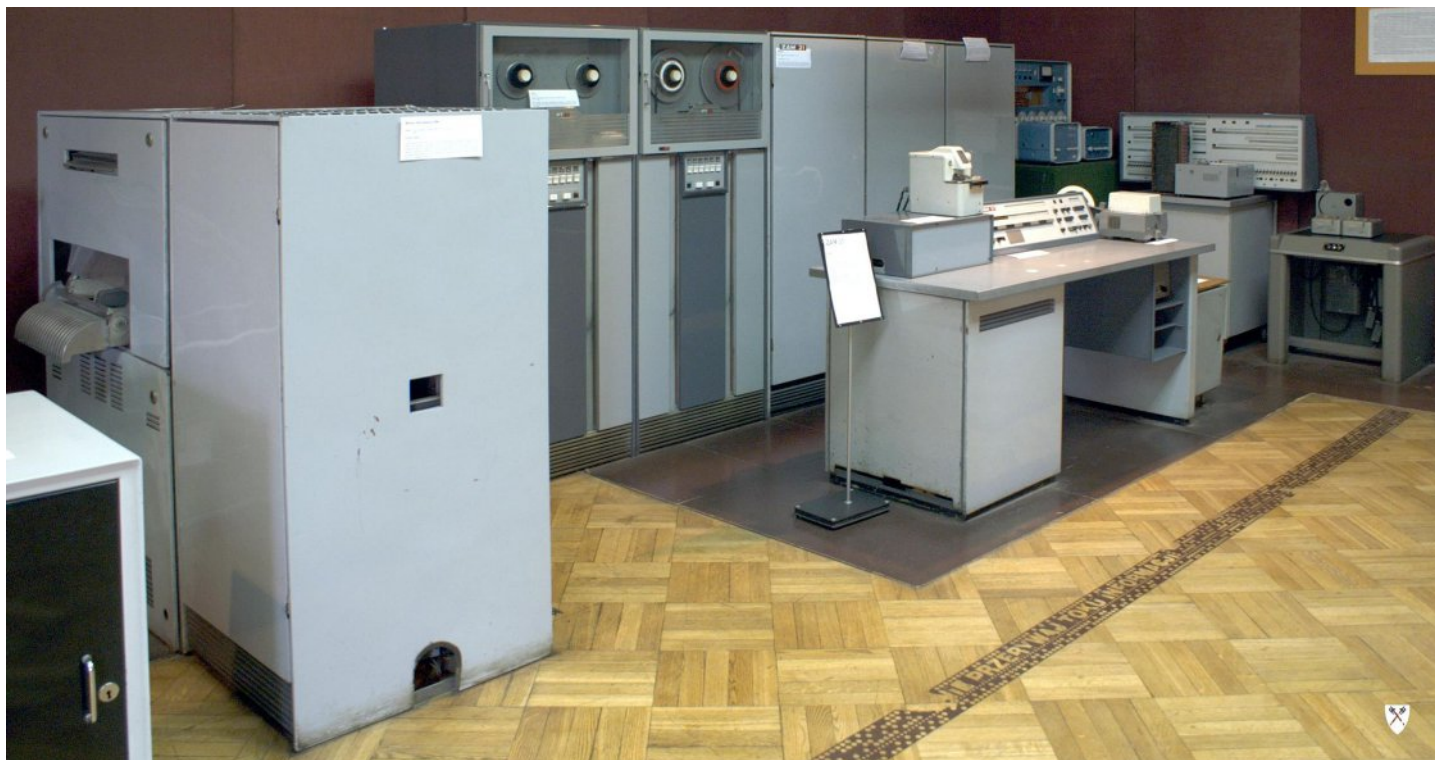
ZAM-21 w warszawskim Muzeum Techniki, mniej więcej po środku widać dwie stacje pamięci taśmowej PT-2, które wyglądają jak przerośnięty magnetofon szpulowy źródło: Topory, praca własna, CC BY-SA 3.0, https://commons.wikimedia.org/w/index.php?curid=4295365
